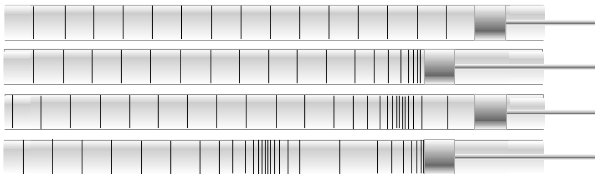
Rys. 1. Wytwarzanie fali podłużnej w rurce z tłokiem
